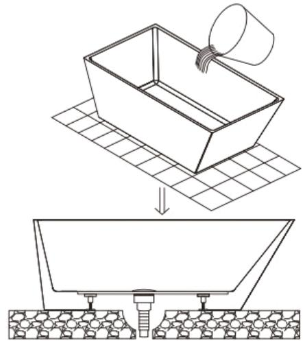
5. Aplique uma camada de silicone à volta da banheira e deixe secar 24h.
