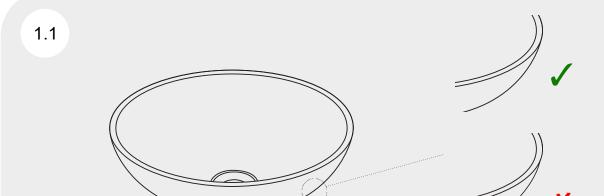
**PT** Verifique se o lavatório não está deformado e que não apresenta golpes ou riscos. Comprove igualmente se o modelo, cor e textura estão corretos. UMA VEZ INSTALADO, NÃO SE ACEITAM ALTERAÇÕES E RECLAMAÇÕES POR QUALQUER UMA DESTAS CAUSAS.
