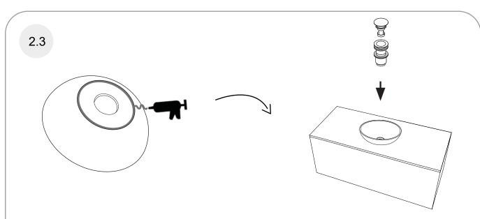
**PT** Uma vez verificado o correto escoamento, retire o lavatório e aplique um cordão de MASSA DE POLIURETANO sobre a base do lavatório, colocando-o de seguida no local predefinido. Proceda com a instalação da válvula.
