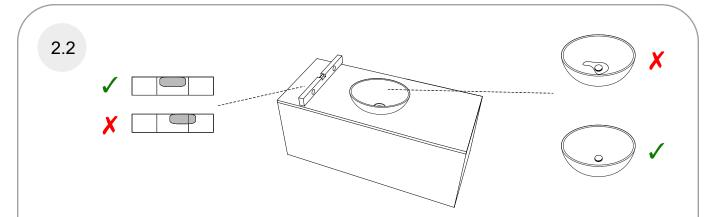
**PT** Antes de instalar o sifão, a torneira, etc, colocar o lavatório sobre o móvel com a válvula instalada, deitar água e verificar se esta corre corretamente para o escoamento, sem que fique à volta da válvula. Esta verificação é muito importante porque, uma vez instalado, NÃO SERÃO ACEITES QUAISQUER REEMBOLSOS E/OU CUSTOS DE SUBSTITUIÇÃO.
