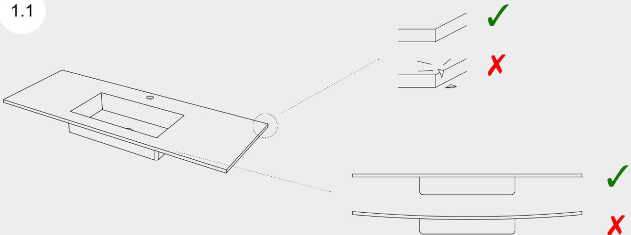
**PT** Verifique se o lavatório não está deformado e que não apresenta golpes ou riscos. Comprove igualmente se o modelo, cor e textura estão corretos. **UMA VEZ INSTALADO, NÃO SE ACEITAM ALTERAÇÕES E RECLAMAÇÕES POR QUALQUER UMA DESTAS CAUSAS.**
