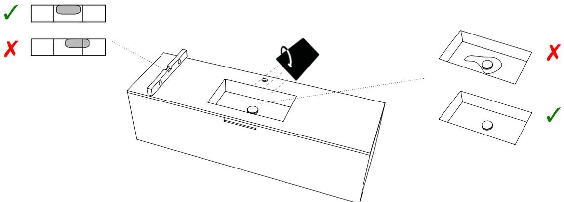
**PT** Antes de instalar o sifão, a torneira, etc, colocar o lavatório sobre o móvel com a válvula instalada, deitar água e verificar se esta corre corretamente para o escoamento, sem que fique à volta da válvula. Esta verificação é muito importante porque, uma vez instalada, **NÃO SERÃO ACEITES QUAISQUER REEMBOLSOS E/OU CUSTOS DE SUBSTITUIÇÃO.**
