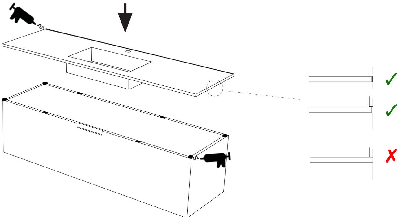
**PT** Uma vez verificado o correto escoamento, retire o lavatório e aplique vários pontos de MASSA DE POLIURETANO sobre o móvel. Aplique também um cordão de massa sobre o perímetro do lavatório que fica contra a parede. De seguida, apoie-o, pressione e elimine o excesso de massa com a ajuda de um cortador. Deixe uma junta de massa de poliuretano de 3-4 mm, entre o lavatório e os elementos adjacentes (azulejos, painéis...).
